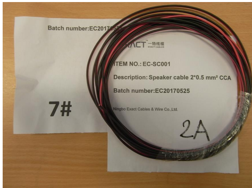
Cable/Cavo: SPEAKER CABLE 2x0,5 mm 2 CCA Marcatura/Marking: Non presente / Not present
