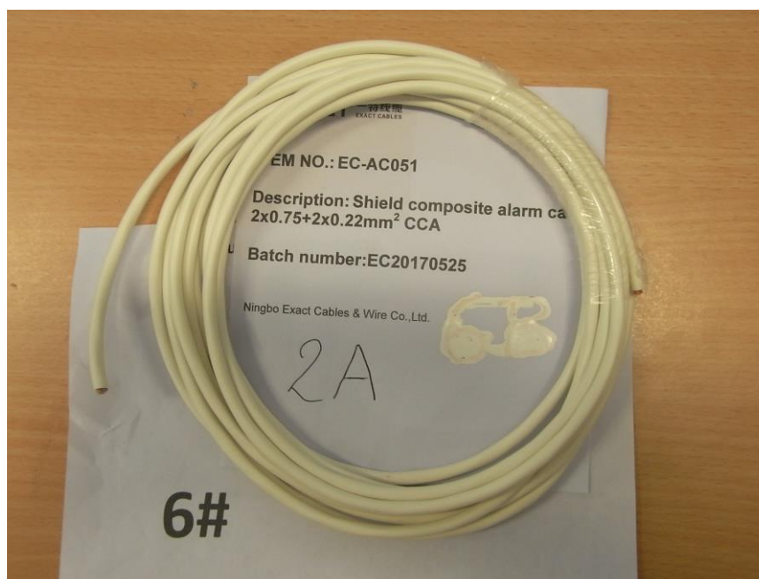
Cable/Cavo: SHIELD COMPOSITE ALARM CABLE 2x0,75 mm 2 + 2x0,22 mm 2 CCA Marcatura/Marking: Non presente / Not present
