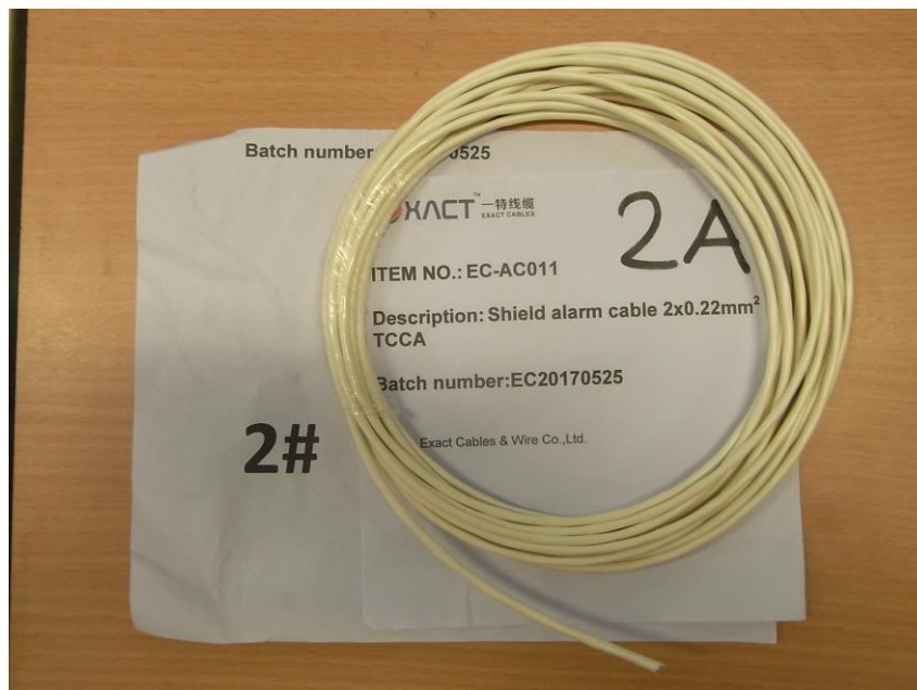
Cable/Cavo: SHIELD ALARM CABLE 2x0,22 mm 2 TCCA Marcatura/Marking: Non presente / Not present
