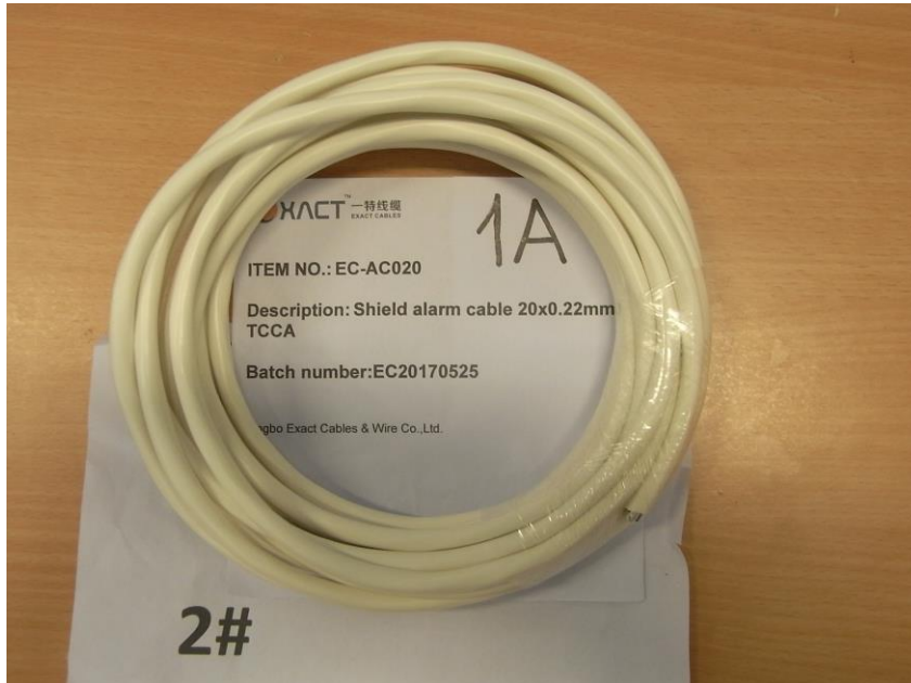
Cable/Cavo: SHIELD ALARM CABLE 20x0,22 mm 2 TCCA Marcatura/Marking: Non presente / Not present
